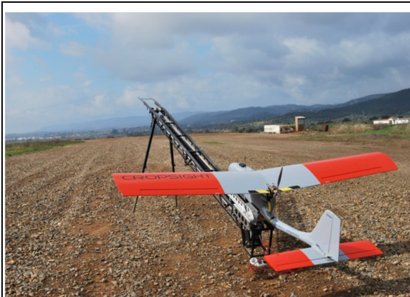
Figura: 3.25a: Lançamento da plataforma aérea
