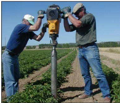
Figura 3.7: Sonda pneumática utilizada na recolha dos monólitos e localização dos pontos de amostragem georreferenciados
