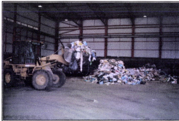
Fotografia 5.5 – “Hall” de recepção dos resíduos sólidos urbanos.
