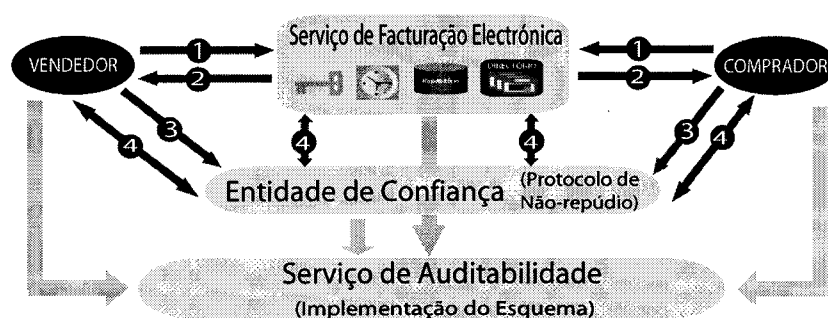
Figura 6.2: Interações entre intervenientes no protocolo de não-repúdio (numera-das entre 1 e 4) e inserções de mensagens no Esquema
