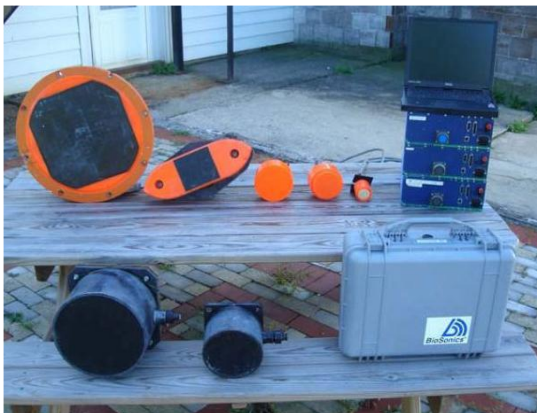
Figura B.1 – Exemplo de transdutores concebidos para diferentes frequências. Na coluna de cima, Simrad a 38, 70, 120, 200 e 710 KHz. e em baixo, Biosonics a 120 e 430 KHz, todos com uma AA de aproximadamente 7°. (extraído de Parker-Stetter et al. 2009)
