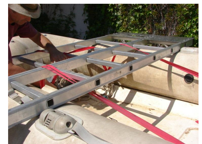
Figura C.7. Fixação do conjunto escadas/placas laterais ao semi-rígido através de 3 poleias
