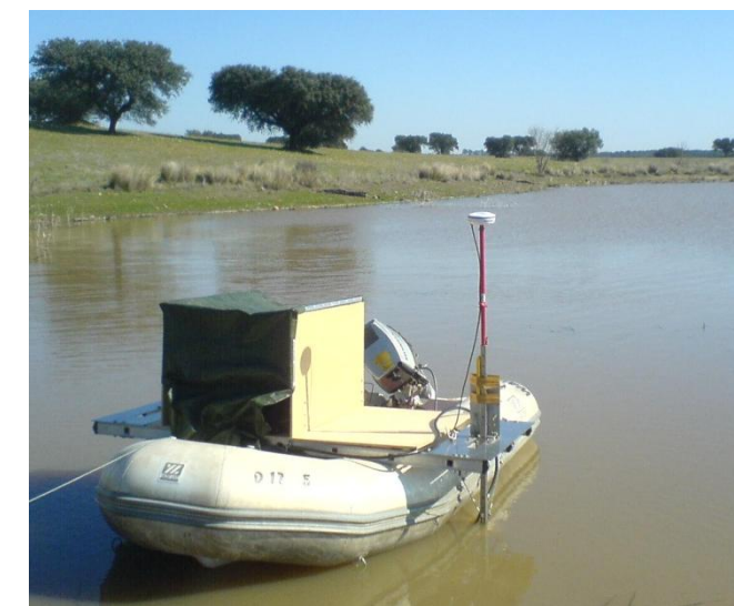
Figura C.11. Colocação do transdutor e do DGPS no varão de suporte e ligação destes elementos ao restante hardware.
