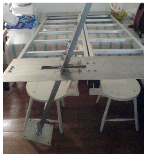
Figura C.8. Montagem do varão de suporte do transdutor na placa lateral esquerda
