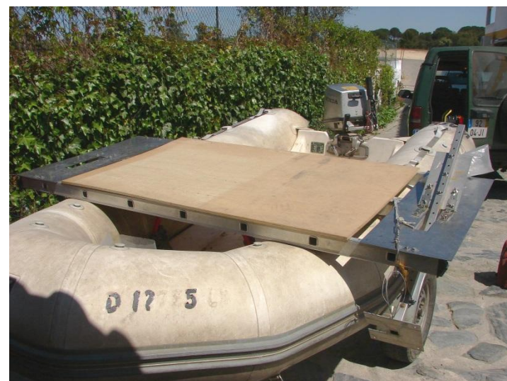
Figura C.9. Colocação da placa central, de suporte da consola e computador portátil
