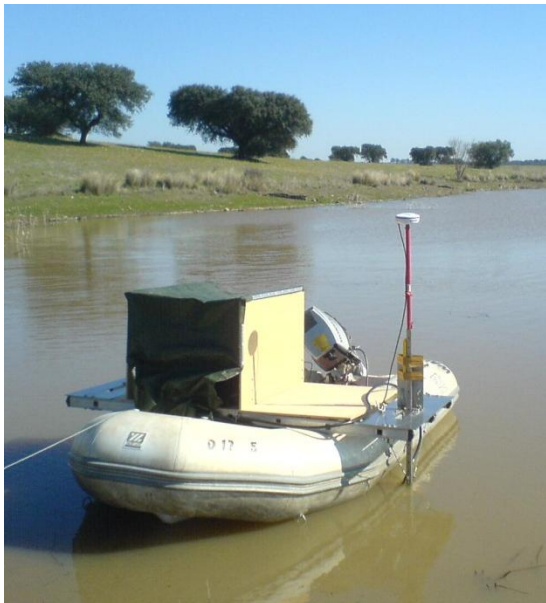
Figura C.49. Conjunto em posição de ecosondagem (esquerda) e em posição de deslocação (direita)
