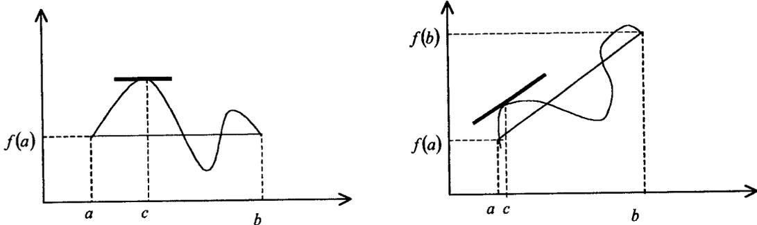
Figura 6.1 Ilustração do teorema de Rolle (à esquerda) e da igualdade dos acréscimos finitos (à direita).
