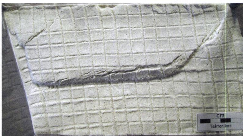
**Fotografia 20** – Fotografia do modelo obtido no estágio final da experiência 8; com cavalgamento central acentuado.
