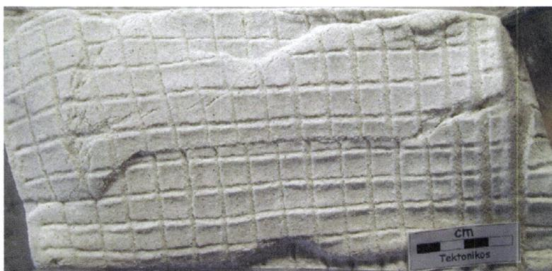
**Fotografia 15** – Fotografia do estágio final da terceira experiência. Observa-se nitidamente um desligamento esquerdo central.
