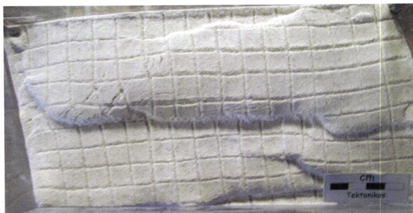
**Fotografia 14** – Estádio final da experiência 2, onde se vê um cavalgamento central muito desenvolvido com algum movimento de desligamento esquerdo associado.
