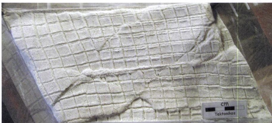
**Fotografia 19** – Fotografia do estágio final da experiência 7, com ângulo de convergência de 22,5°.
