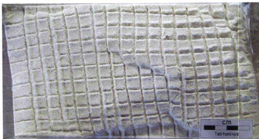
**Fotografia 12** – Fotografia do estágio final do modelo transpressivo da experiência 1.
