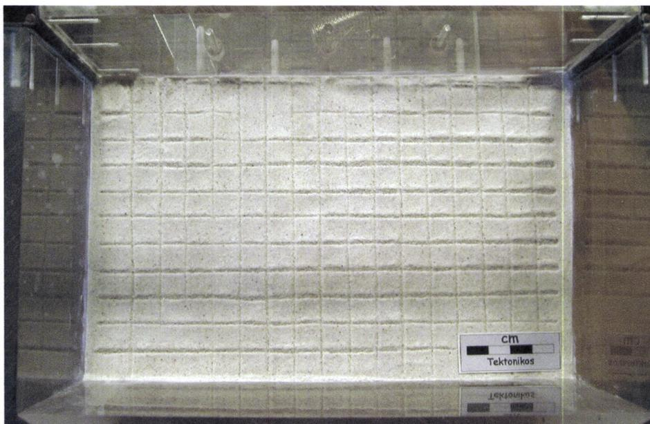
**Fotografia 8** – Modelo ao qual vai ser induzida uma transpressão em cuja superfície de areia e farinha se pode observar a malha ortogonal desenhada que servirá de referência para se poder quantificar a deformação.
