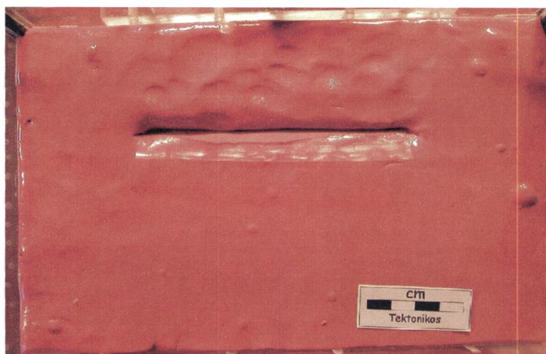
**Fotografia 9** – Anisotropia simulada pelo acetato (visão vertical) quando colocada no silicone.
