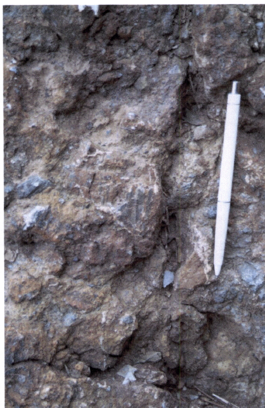
Fotografia 6 – Estrias de falha correspondentes à fotografia 5 com atitude 60°; N20°E.
