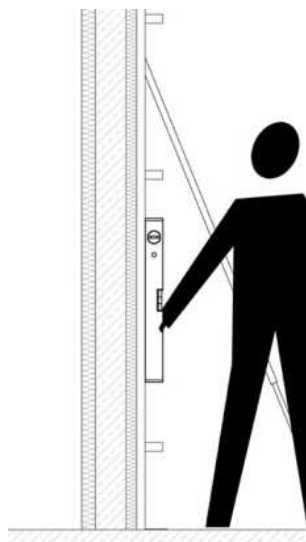
Fig. I.40 – Figura exemplificativa de verificação de aprumo (ARGISOL, 2010).
