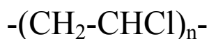
Figura 18- Unidade repetitiva de poliloreto de vinilo (PVC) (n representa o número de monómeros) [24].
