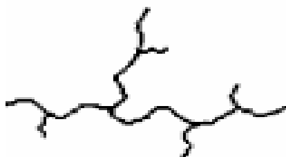
Figura 5 - Estrutura de um polímero de cadeia ramificada [18].
