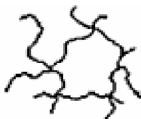
Figura 6 - Estrutura de um polímero de cadeia reticulada ou cruzada [18].
