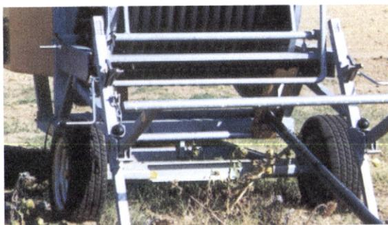
**Figura 3. 11** - Guia do tubo de polietileno
