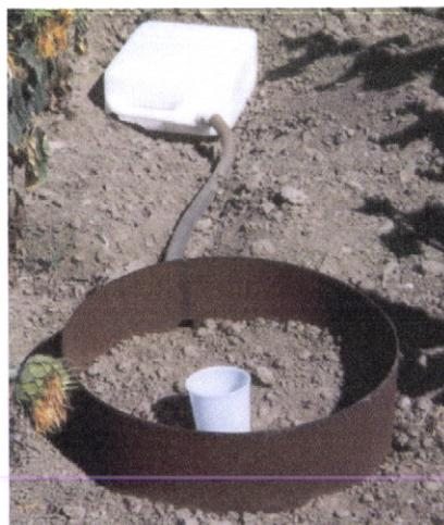
**Figura 3. 34** - Anel infiltrómetro diferencial
