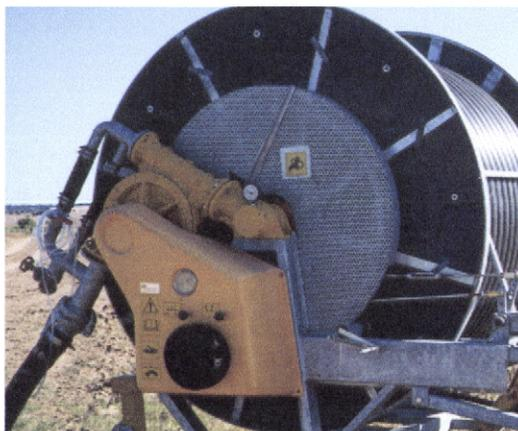
**Figura 3. 12 - Sistema de turbina de fluxo parcial**
