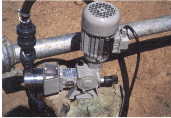
**Figura 3. 30** - Bomba utilizada para aplicação de PAM
