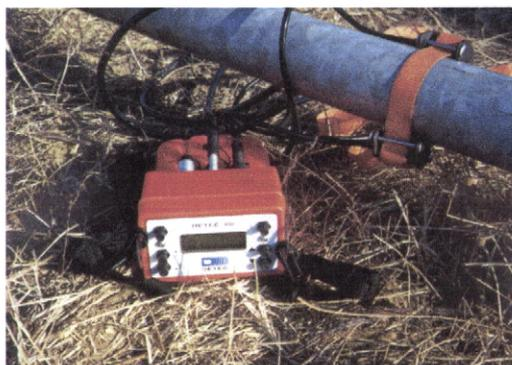
**Figura 3.32 - Caudalímetro ultra-sónico**
