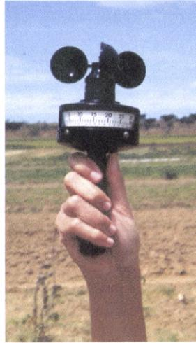
**Figura 3. 25 - Anemómetro portátil**
