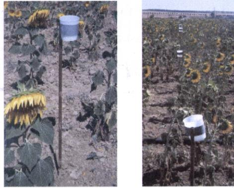
**Figura 3. 21** - Pluviômetros utilizados nos testes de avaliação
