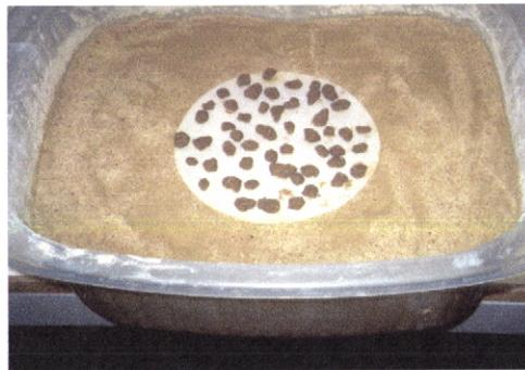
**Figura 3. 28-** Pré-humedecimento dos agregados
