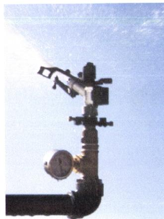
**Figura 3. 15** - Manómetros instalados nos aspersores
