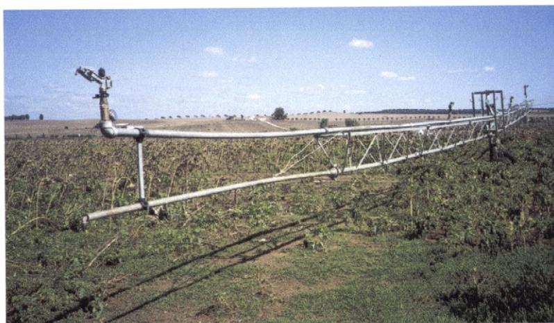
**Figura 3. 14** - Barra com os quatro aspersores utilizados nas regas
