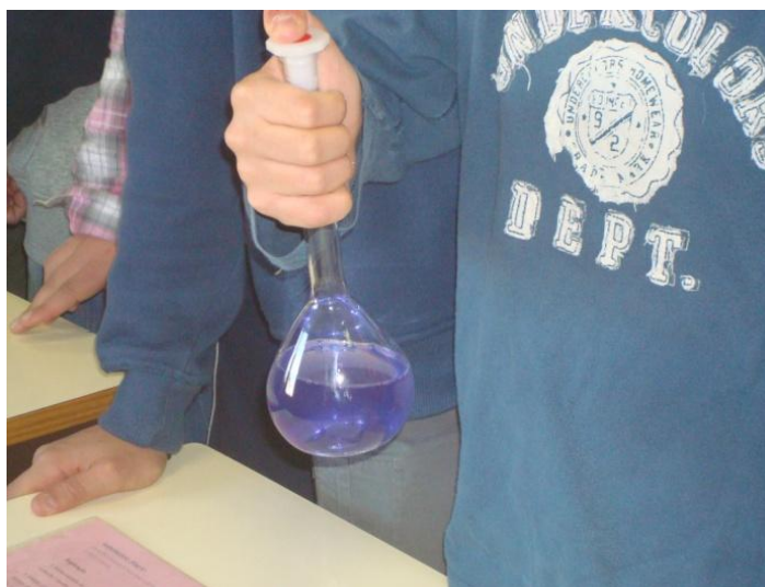
Figura 21 - Solução de glicose com hidróxido de potássio, em equilíbrio químico mudando de cor entre azul e incolor, após agitação/repouso.
