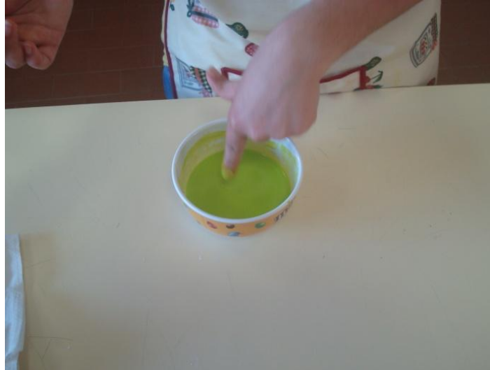
Figura 22 - Fluido não newtoniano preparado com farinha maizena e água.
