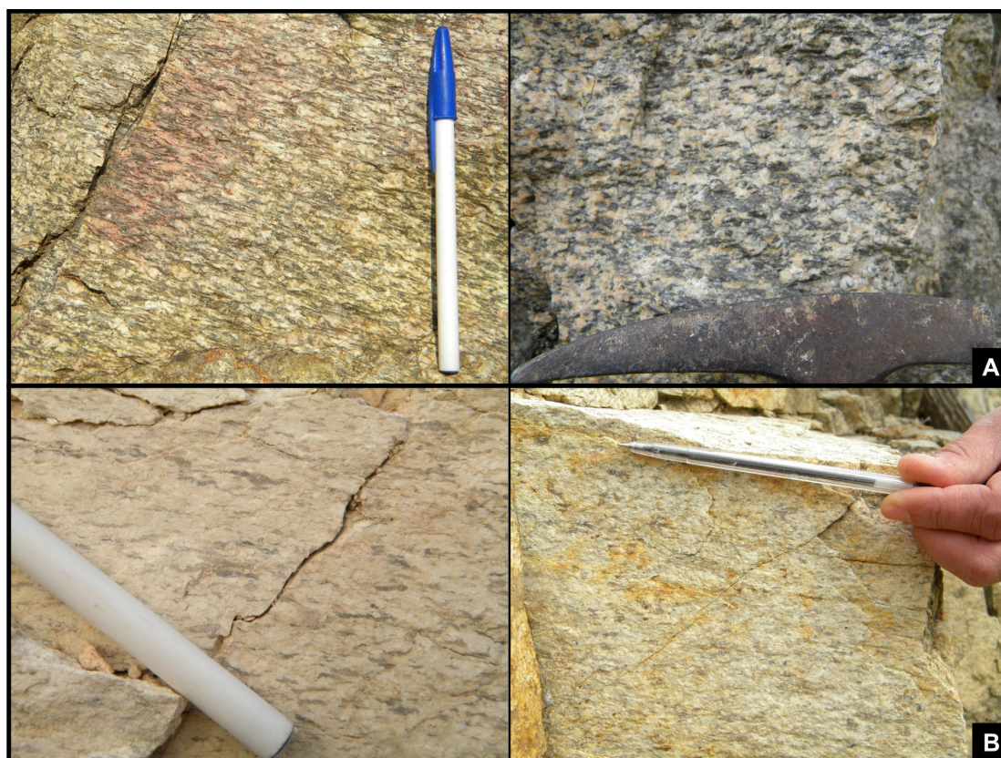
Fig. 7.20 – Aspectos texturais comuns exibidos macroscopicamente pelo granito sin-tectónico de Maiorga: A – bandado gnaissico com ocelos de feldspato; B – texturas miloníticas.
