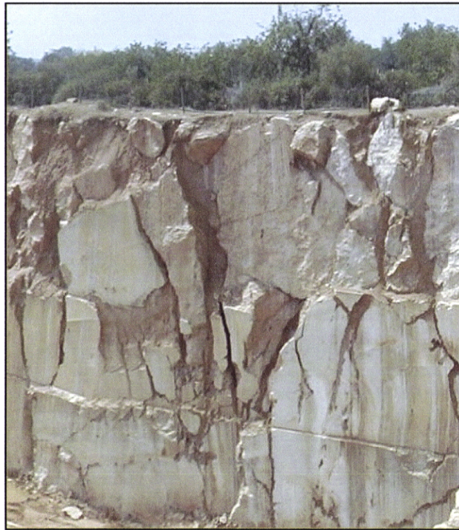
Fig 4.18: Variação vertical da distribuição e abertura das fracturas. Pedreira na zona de Sto. Estêvão.
