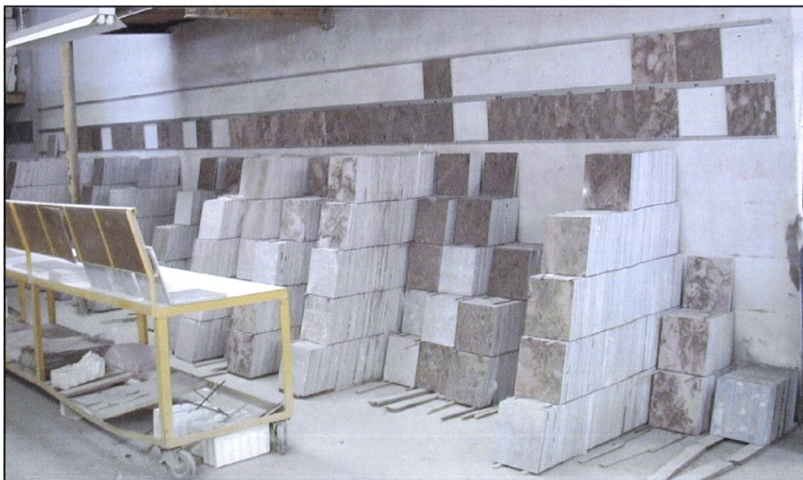
Fig: 5.4: Processo de selecção da "Brecha" em sub-tipos diferentes, durante o processo de transformação.
