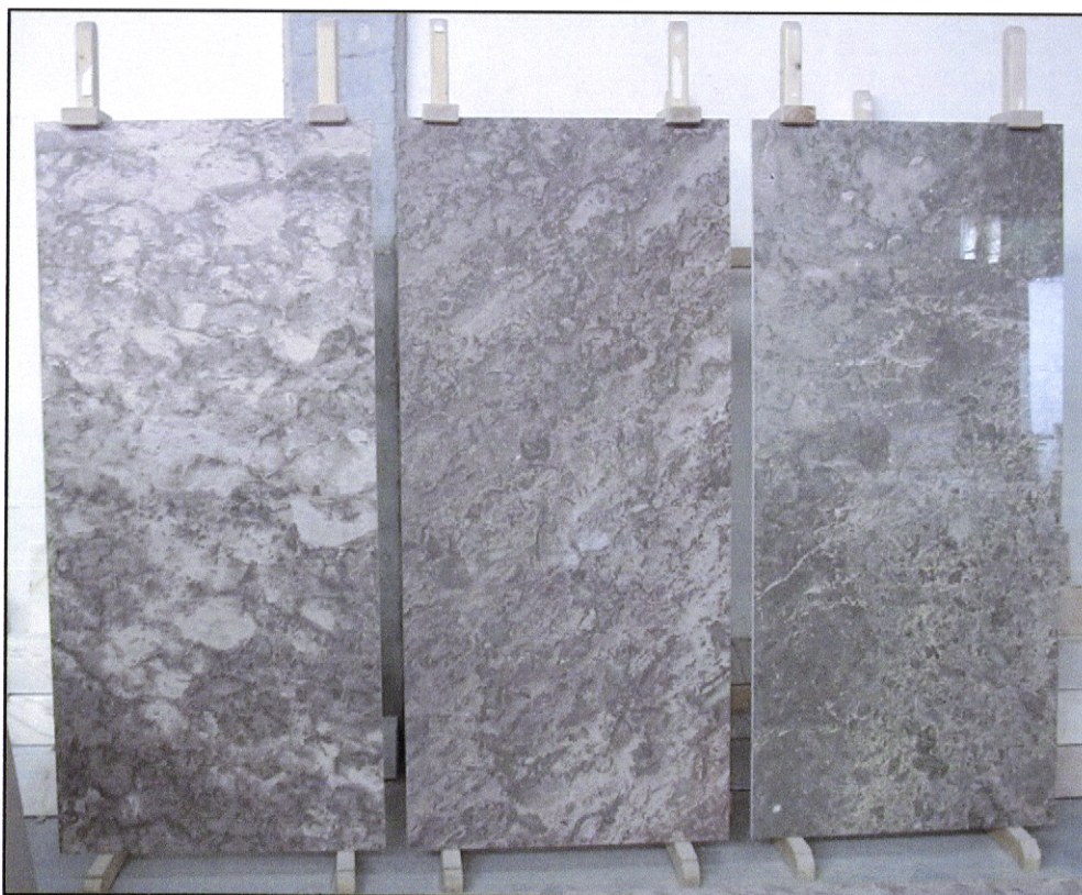
Fig. 4.3: Chapas polidas de três litótipos de "Brecha Algarvia" explorada na zona da Mesquita.
