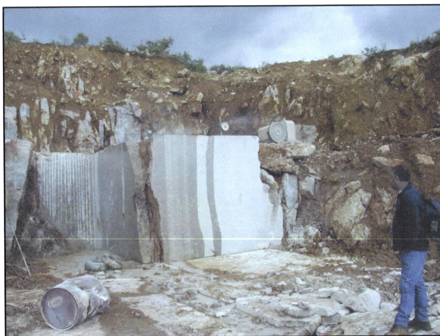
Fig. 4.2 Operação de corte com fio diamantado.
