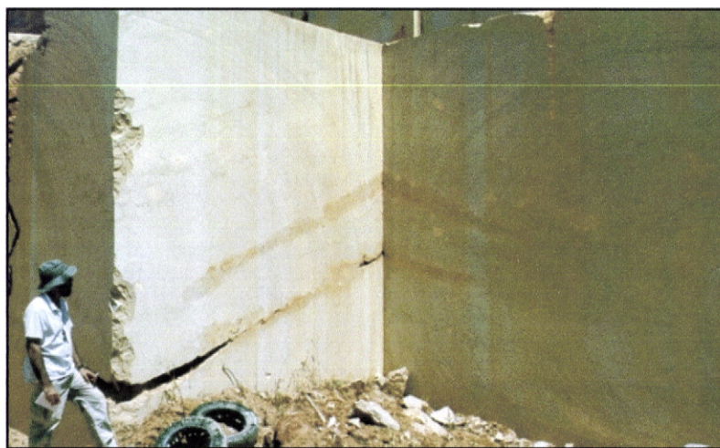
Fig. 4.21: Traço de um plano de estratificação, denotando abertura, observado nas paredes de uma pedreira em Sto. Estêvão.
