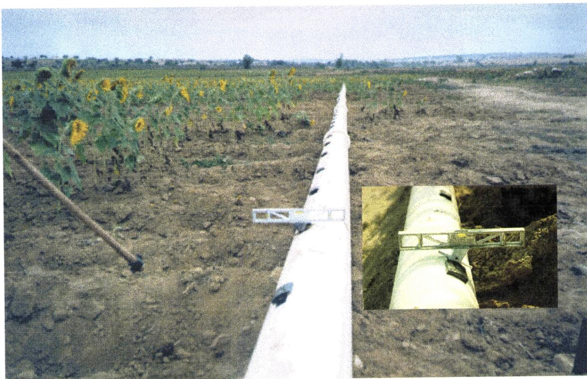
*Figura 4.2. Aspecto do tubo do Cabo-rega, com as janelas rectangulares abertas na posição máxima. Ao lado pode-se ver o nível utilizado para a colocação das janelas a um ângulo de 30°.*
