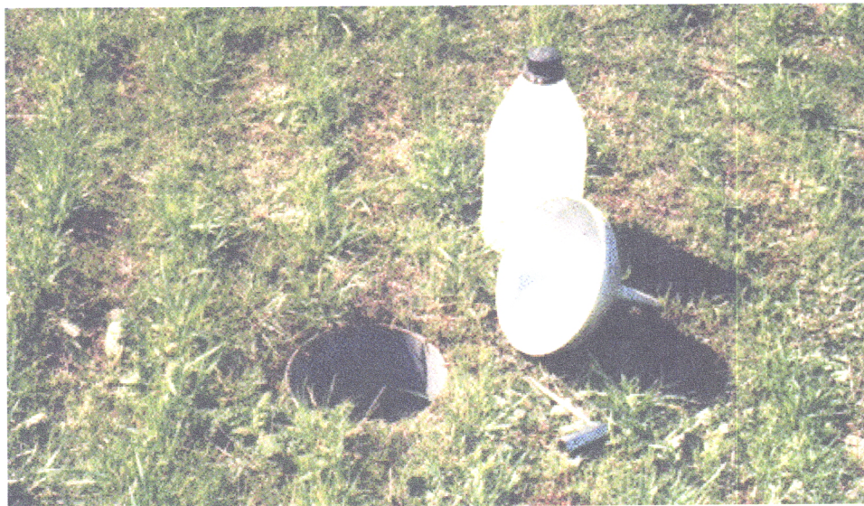
Figura 3.4 Imagem dos 3 elementos que compõem o aparato de recolha de salpicos (funil, garrafa e cilindro em PVC).
