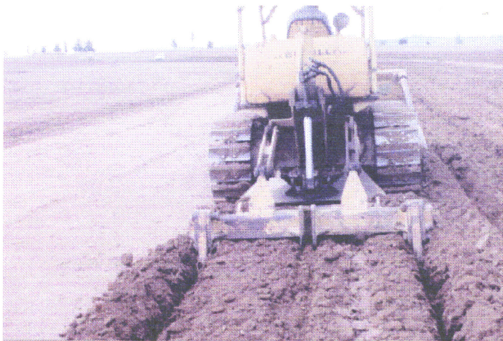
Fig. 5 - Realização da subsolagem ligeira. O tractor estava a trabalhar com dois ferros de subsolagem (dentes de “ripper”) separados de 1,5 m, pelo que no itinerário inverso um dos ferros passaria entre os itinerários que agora estão a ser praticados.
