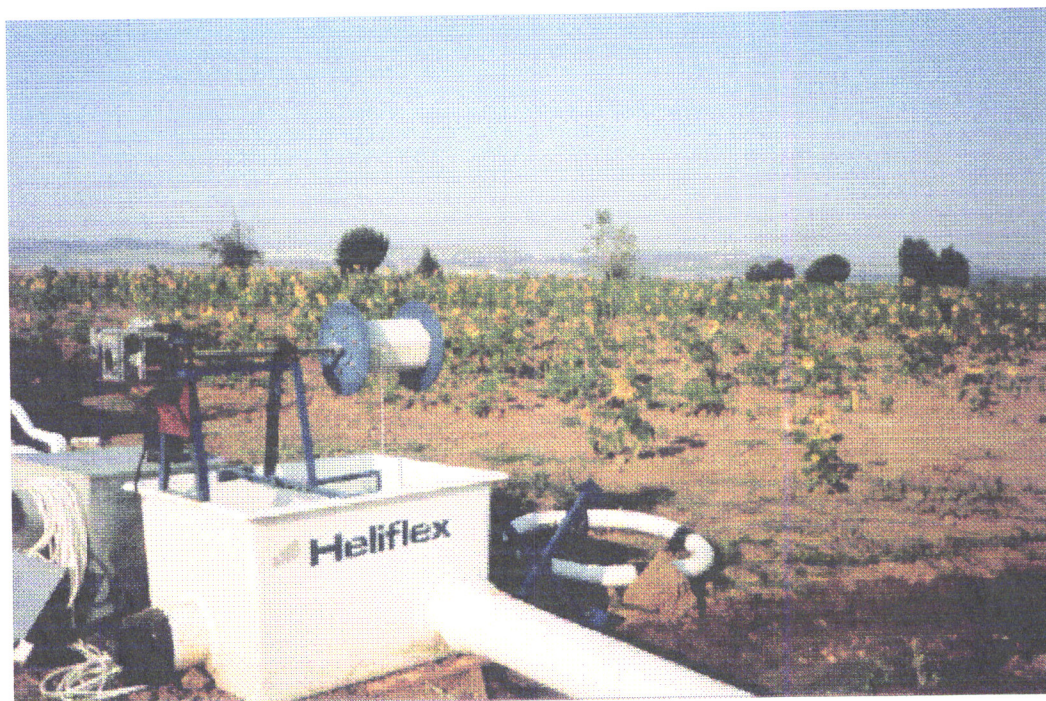
Fig.1 - Aspecto geral da caixa e mecanismos de funcionamento do Cabo-rega.
