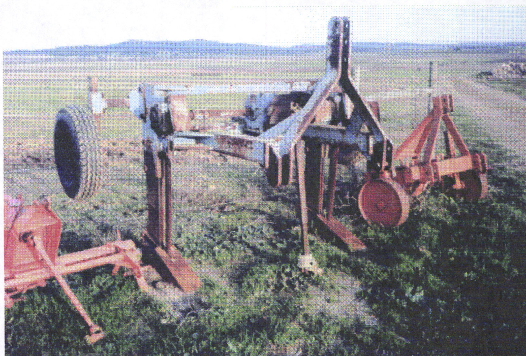
Fig. 3 - Subsolador vibrador de dois ferros separados de 1,5 m. Os ferros são pernas com pés oscilantes, ligados por um tirante à tomada de força do tractor, que lhes confere um movimento de oscilação ou “vibração”.
