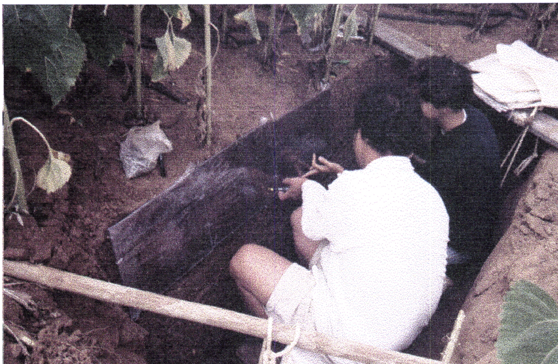
Fotografia 5 - Pormenor do perfil e fixação do painel em módulos de vidro acrílico revestido a plástico cristal e fixados com pregos
