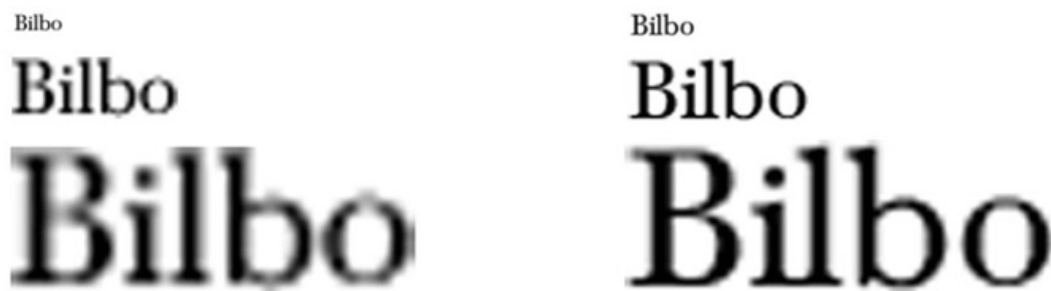
Fig. 09 | Melhoramento visual dos caracteres em baixa resolução depois de aplicar o "hinting"
