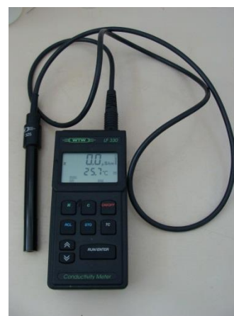
Figura 15 – Medidor de CE (LF 330). Foto do autor.
