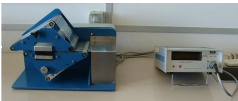
Figura 18 – Medidor de área foliar (LI-COR Model LI-3000, Lambda Instruments Corporation). Foto do autor.
