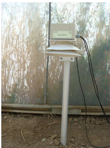
Figura 13 – Estação meteorológica (Helios Mini V400). Foto do autor.
