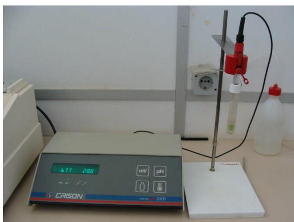
Figura 14 – Medidor de pH (Micro pH 2000, Crison). Foto do autor.
