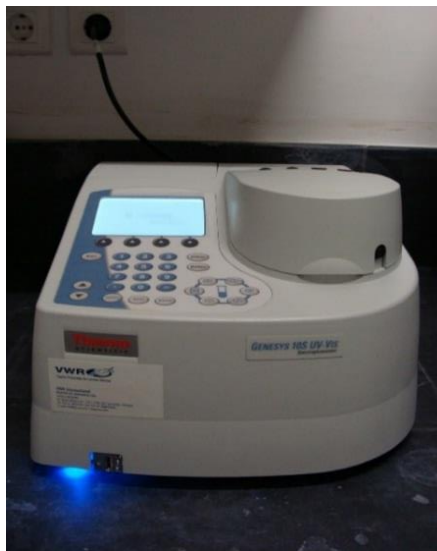
Figura 23 – Espectrómetro de absorção molecular (Thermo Scientific, Genesys 10S UV-VIS) utilizado nas leituras das absorvências. Foto do autor.
