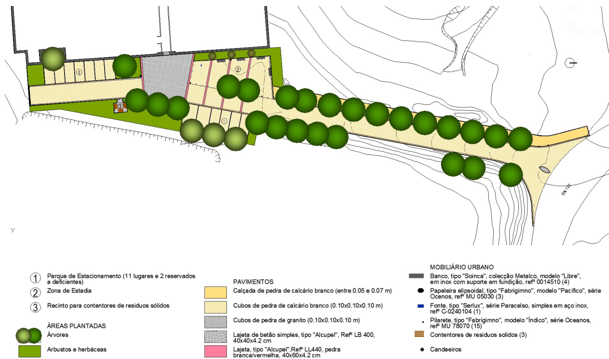
Figura 30 - Extrato do Plano Geral do projeto da entrada do cemitério de Castro Marim.
