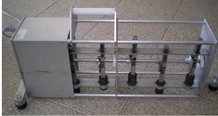
Figura 2.5 – Máquina de impactos ou de percussão normalizada (Retec Instruments RI069)
