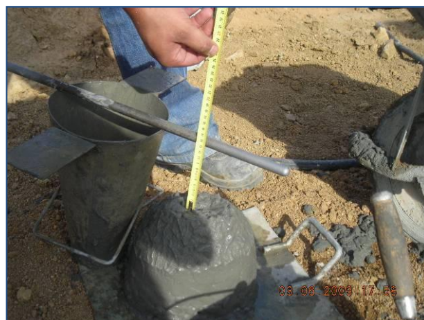
Figura. 5 – Ensaio de consistência do betão - “Slump”
