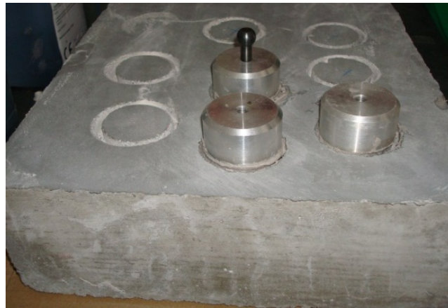
Figura 31: Colagem das pastilhas à lajeta.
