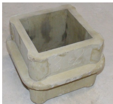
Figura 20: Molde com produto descofrante.
