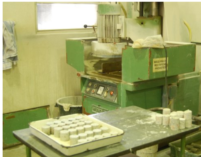
Figura 26: Rectificação das carotes.
