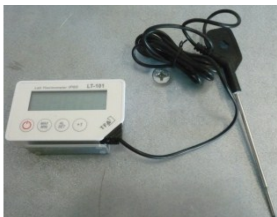
Figura 38: Termómetro usado para registar a temperatura do betão.
