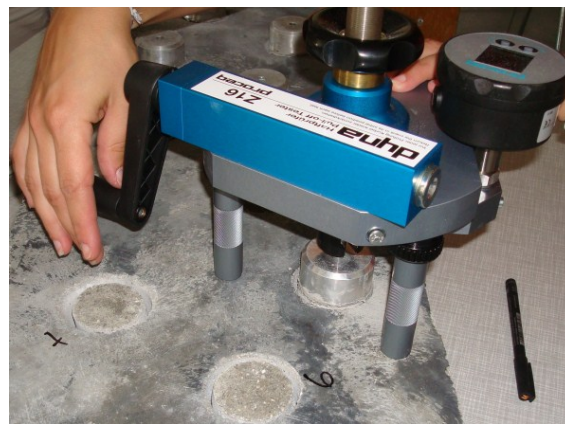
Figura 32: Realização ensaio de Pull-Off.
