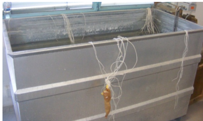
Figura 22: Tanque de cura.
