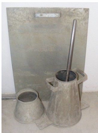
Figura 5: Cone de Abrams.
