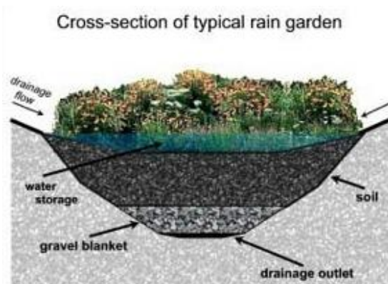
Figuras 37 e 38 - Bacias de infiltração/ “Rain Garden”. À esquerda, corte esquemático das bacias de infiltração e à direita, a presença da vegetação no sistema. Fontes: http://www.tipthepianet.com/wiki/Rain_gardens e http://www.shorelineareanews.com/2012/11/rain-gardens-coming-soon-to-your.html
