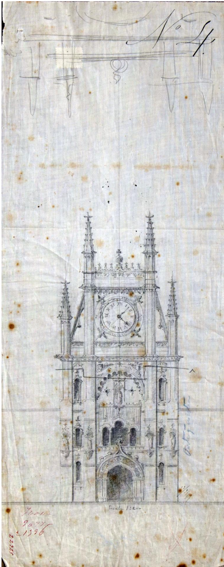
Des. 33 A – Projecto para o corpo central da fachada sul do Mosteiro dos Jerónimos. Desenho n.º 4. Esc.: 1:200. Rafael da Silva Castro, 13/9/[18]79. ANBA Gav. 5, pasta 60, n.º 907. Vol. I, tomo 1, pp. 474.
