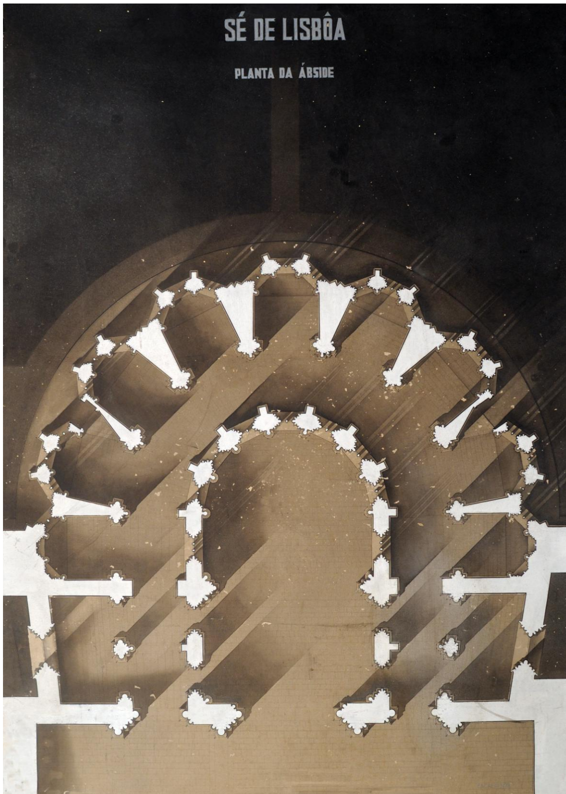
Des. 99 – Sé de Lisboa. [Reconstituição da abside]. Planta da abside. S/escala [1:20]. S. d. [Anos 30]. Arquitecto: [António do Couto]. Papel cartonado, pintado a guache. AHMOP – R 38 1 D. Reprodução de Pedro Aboim. Vol I, tomo 2, p. 1311.
