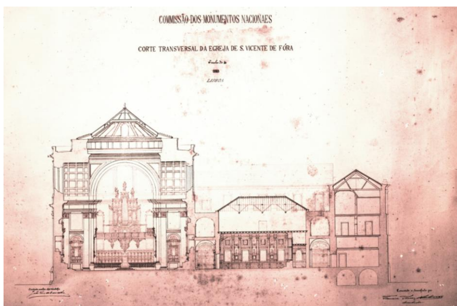
Des. 19 – Comissão dos Monumentos Nacionaes / Corte Transversal da Igreja de S. Vicente de Fora / 1883 / Lisboa . Esc.: 1:100. Levantado e desenhado por Francisco Soares O'Sullivan, desenhador. O Conductor auxiliar, chefe dos trabalhos João Lino de Carvalho. Original, Cartolina: 130,8 x 87,7. ANBA – Gaveta 1, Pasta n.º 19 -Rolo 19 A, n.º 569 (Foto 273). Perdeu-se o original. Só existem o negativo e o positivo fotográficos. Inédito. Vol. I, tomo 1, p. 268, Vol. II, p.12.
