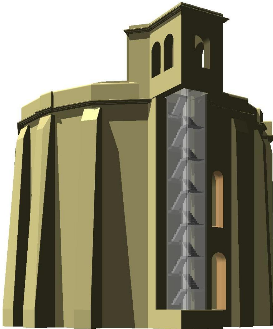
Fig. 269 – Modelo tridimensional da Charola com corte da torre do relógio . Desenho do arquitecto Sotero Ferreira, 2007. Inédita. Vol. I, tomo 2, p. 1282.
