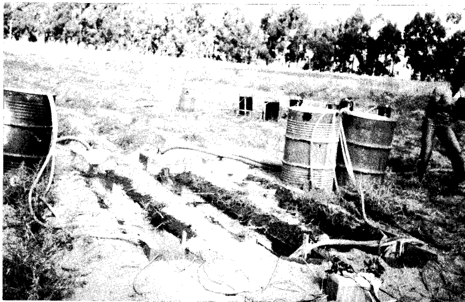
Foto 4 - Infiltrômetro de sulco com retorno
