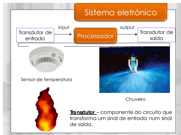
Figura 32 - Exemplo do processamento de sinais num sistema eletrônico.
