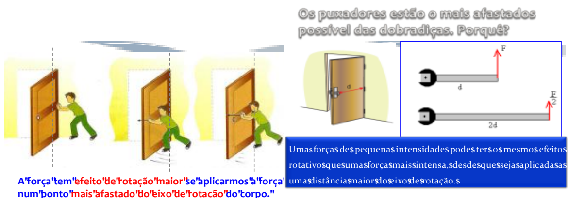
Figura 29 - O efeito de rotação provocado pela aplicação de uma força.
