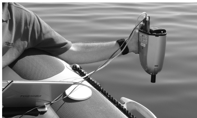
Figura 2.6 – Fotografia tirada no dia 30 de Junho 2011 na albufeira de Alqueva. Medição da reflectância de superfície com o espectrorradiómetro portátil FieldSpec UV/VNIR da Analytical Spectral Devices Inc. (Boulder, CO, USA).
