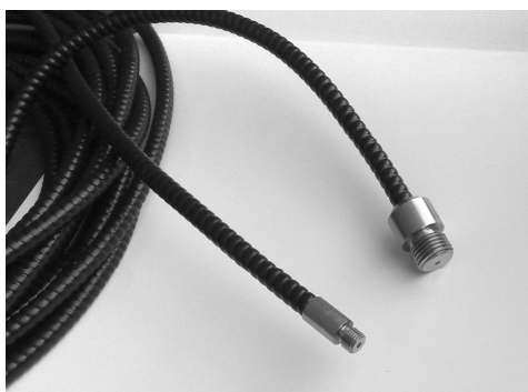
Figura 2.7 – Fotografia do cabo óptico utilizado em conjunto com o espectrorradiómetro portátil. A ponta larga é acoplada ao espectrorradiómetro enquanto a ponta pequena é fixa à estrutura de suporte.
