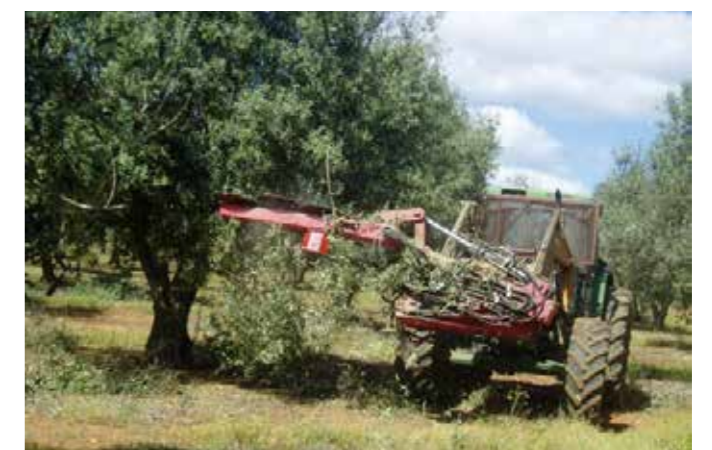
Fig. 13 – Corte horizontal da copa máquina de podar de discos (Herdade Torre das Figueiras, Monforte, 2001).
