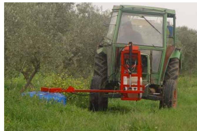
Fig. 26 - Controlo da vegetação na linha usando pulverizadores, herbicida diluído (Herdade dos Lameirões; Safara, 2003).
