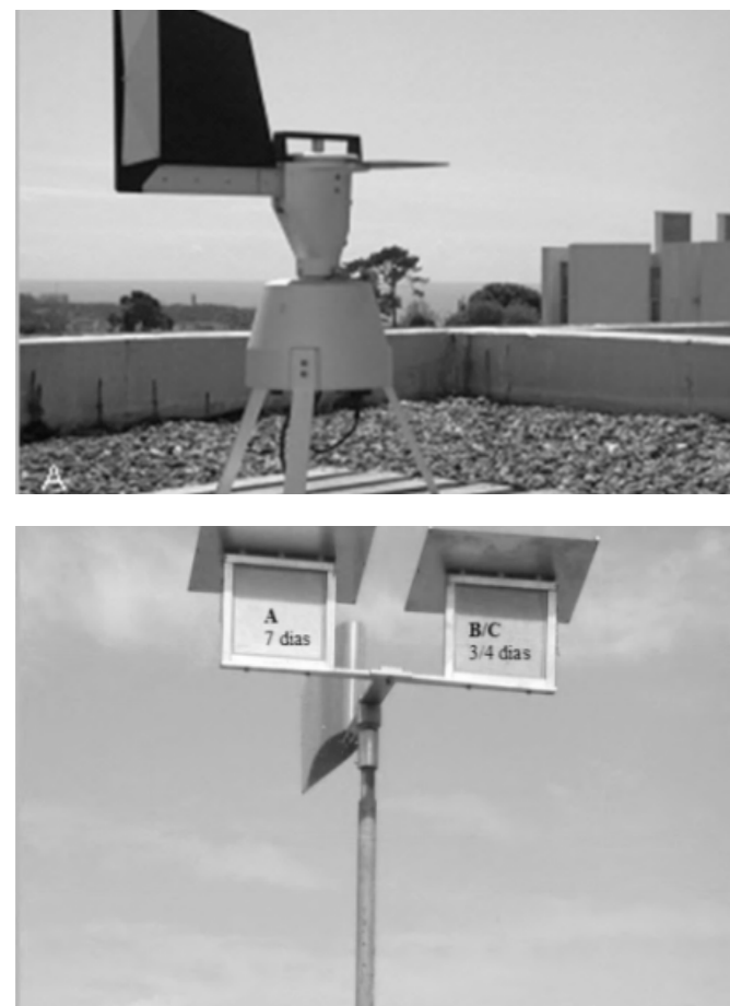
Fig. 4. Captadores Tipo Hirst (A) e Tipo Cour (B) apresentando um interceptor de fluxo, orientam-se de acordo com a direcção do vento.
